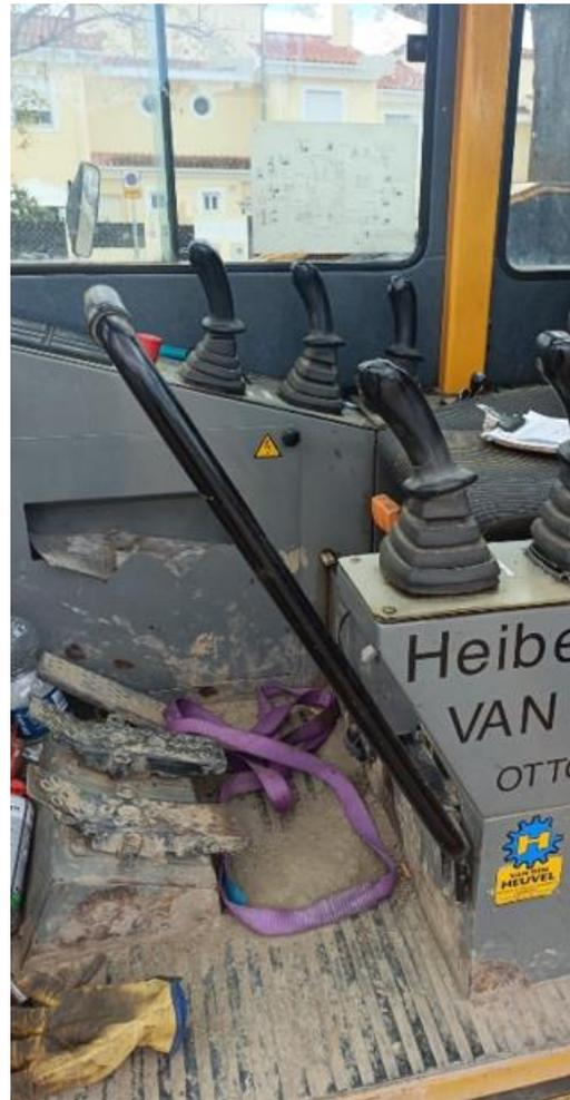
5. CON EL JOYSTICK DELANTERO DEL LADO DERECHO, MOVER LAS ORUGAS SIGUIENDO EL ESQUEMA ADJUNTO. PRECAUCION, EL REDUCTOR DE LAS ORUGAS ESTÁ ATRÁS.
