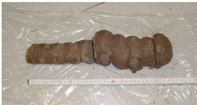
Figura 10. Formação de colunas de brita.
