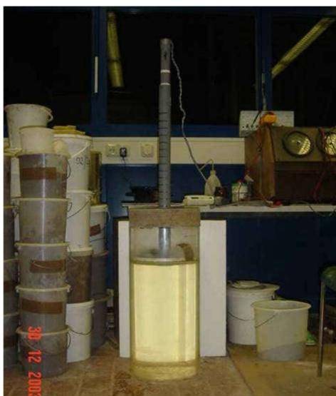
Figura 9. Formação de colunas de brita.
