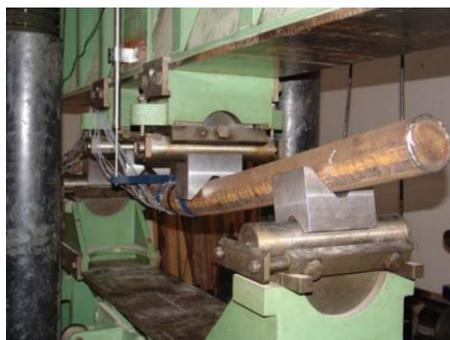
**Figura 4.** Estudio experimental sobre el comportamiento estructural de uniones de micropilotes. AETESS. España. 2009. Tomada de [8]
